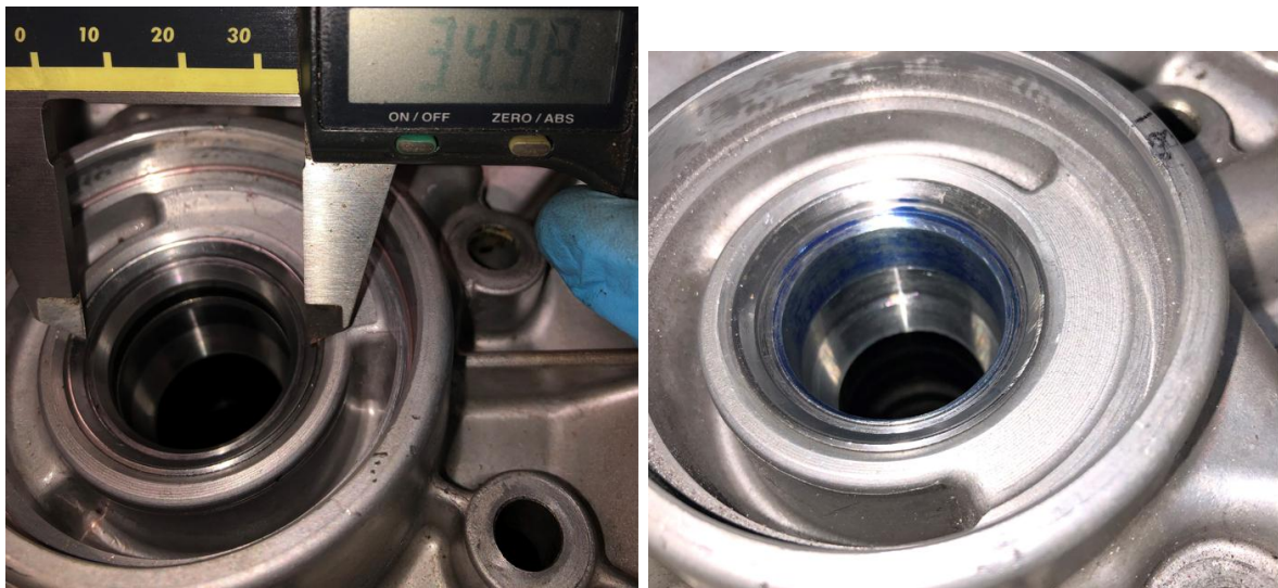
Restauration Teil 3: Labyrinth-Dichtung Getriebe Primärwelle, Vorderachse
