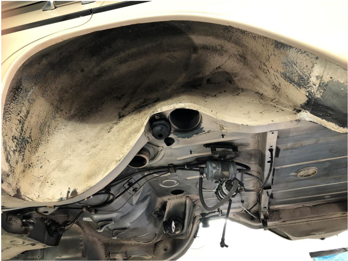
Restauration Teil 3: Zustand nach Trockeneisstrahlen
