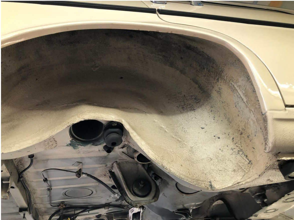
Restauration Teil 3: Zustand nach Trockeneisstrahlen
